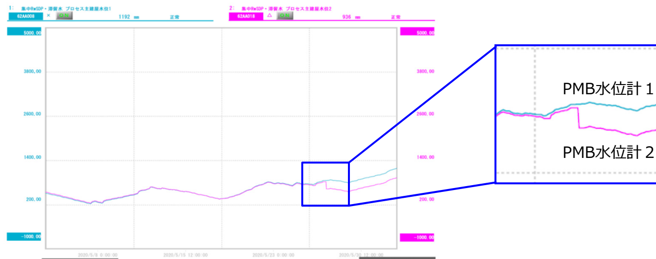
2020/5/27 水位計2設置高さ修正時のPMB水位トレンド
