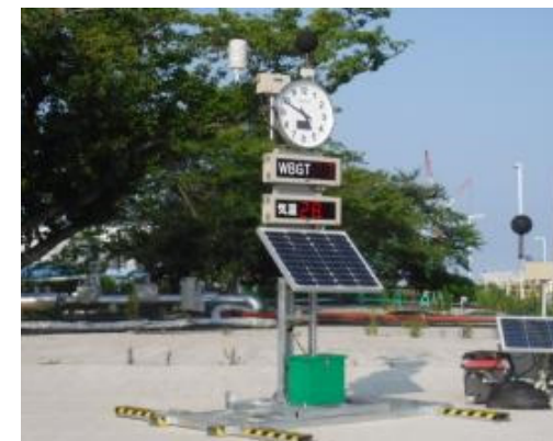
大型WBGT表示器、時計の配備
