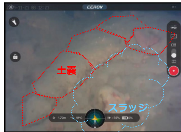
HTIの土嚢周辺状態(現在)
