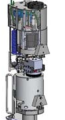
図4 サンプル回収装置 (フレキブルグリッパタイプ)
