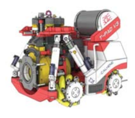
図5 燃料デブリ収納容 の遠隔輸送台車
