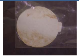
1号機X-2ベネ堆積物除去治具のスマヤ 外観（直径約5cm）
