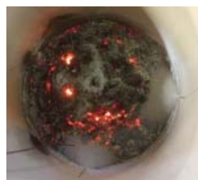
図1 模擬燃料デブリの作成
