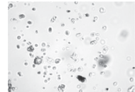
ダストの試料（拡大率4000倍、 <1 \mu\text{m} ）
