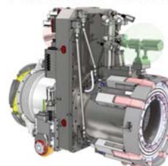
図3 X-6ペネ接続構造
