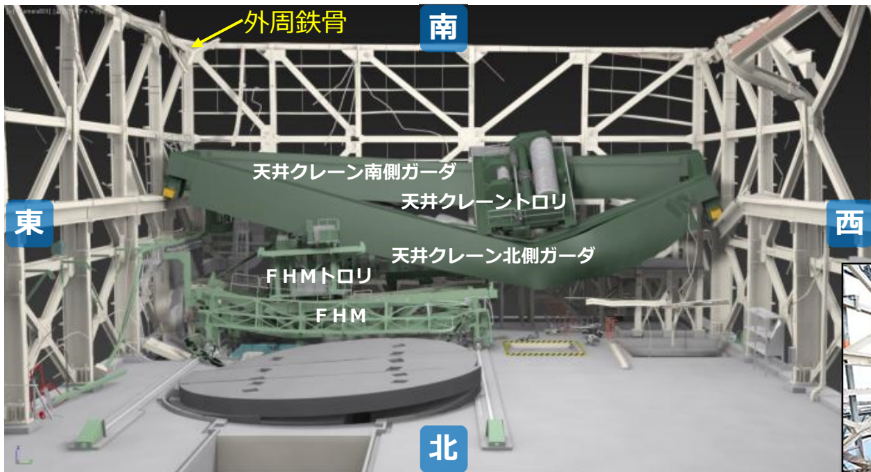
天井クレーン・FHMのイメージ図 (3Dスキャン結果と写真を基に作成、配置図A方向)
