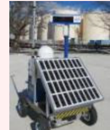
線量率モニタの設置状況
