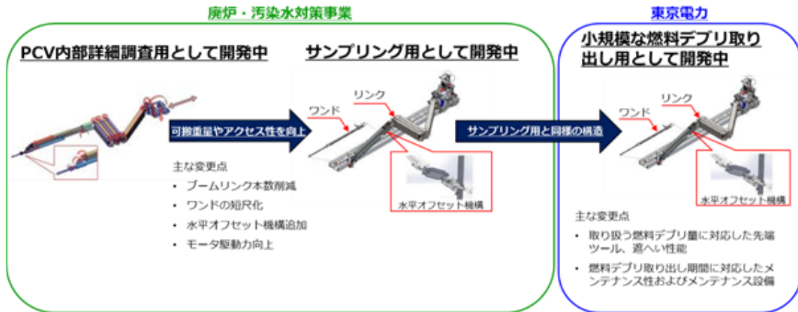
図 A7-7 小規模な取り出し装置に関する概念図（東京電力資料を NDF にて加工）
