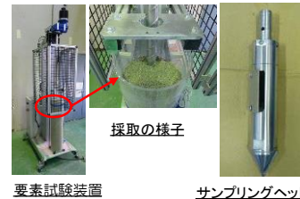
図19 セシウム吸着塔から使用済吸着材を採取するための採取試験装置とサンプリングヘッド
