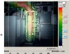
図3 熱カメラによる1号南側調査結果 (AC系配管のホットスポット)
