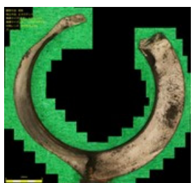
下流側(破面側) 実体顕微鏡像
