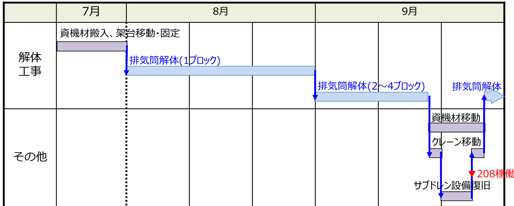
排気筒解体工事 工程表
