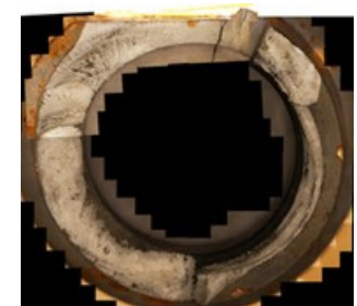
上流側(破面側) 実体顕微鏡像
