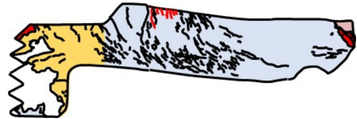
上流側継手破面 (細切断後, 90° 側から観察)
