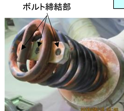
分離したガレキ撤去ツール(熊手)の下部
