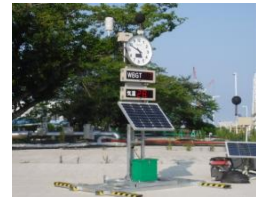
大型WBGT表示器、時計の配備
