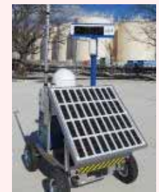
線量率モニタの設置状況
