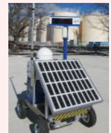
線量率モニタの設置状況
