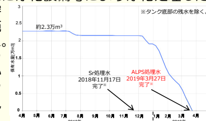
フランジ型タンク内ALPS処理水の移送状況
