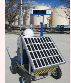
線量率モニタの設置状況
