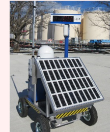
線量率モニタの設置状況
