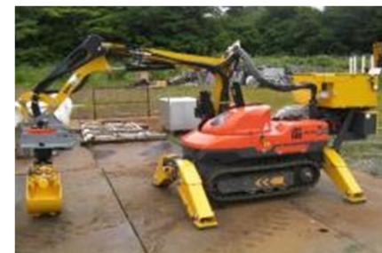
BROKK100D 主な役割 ・ 残置物(小物)の片付 ・ フェンスの切断・片付 等
