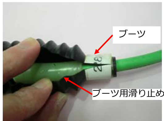
①ブーツ用滑り止めのずれ
