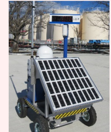
線量率モニタの設置状況
