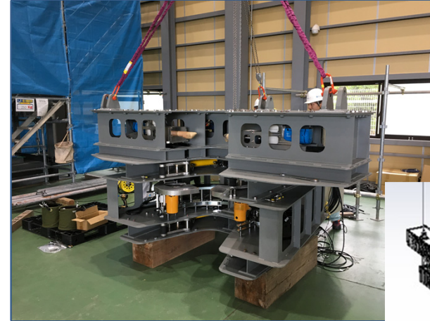
鉄塔解体装置（主柱材用）組立状況
