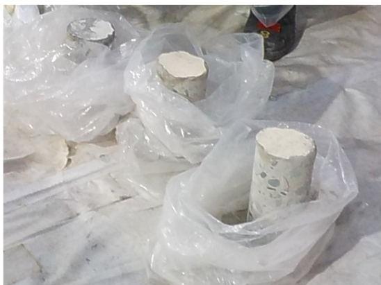
調査用コア採取状況
