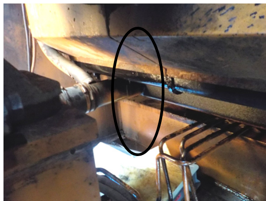
図1 750tクレーン（2号機） オイルクーラー不具合
