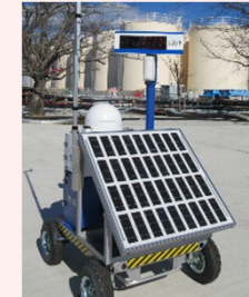
線量率モニタの設置状況
