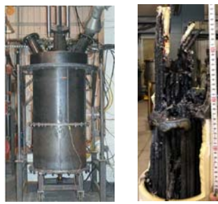
図3 模擬燃料集合体プラズマ加熱試験
