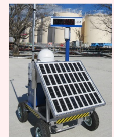
線量率モニタの設置状況
