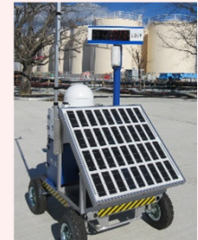
線量率モニタの設置状況
