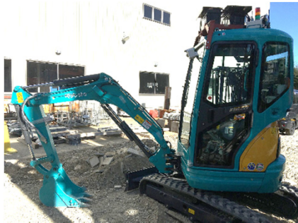
遠隔重機によるルーフブロック撤去イメージ
