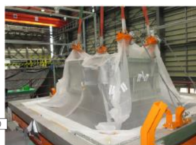
汚染拡大防止用シートによる搬出性確認試験
