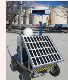
線量率モニタの設置状況
