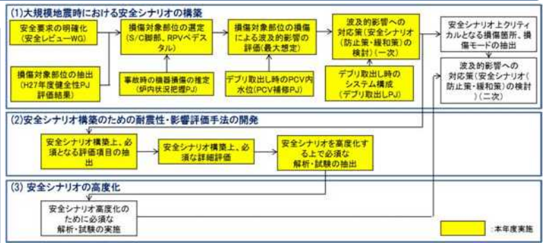
図1 大規模地震時の安全シナリオ構築のための全体検討フロー
