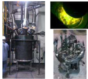
図3 模擬燃料集合体プラズマ加熱試験 (予備試験の装置・加熱状況・試験体)
