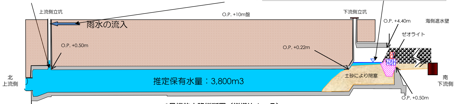
1号機放水路縦断面図（縦横比1：5）
