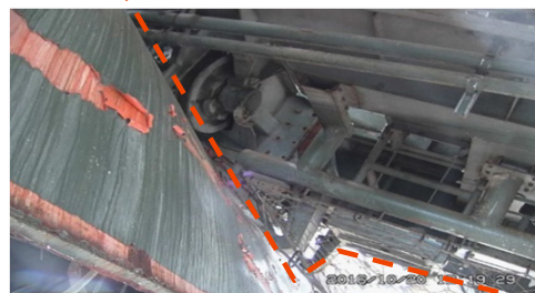
天井クレーン北側ガーダの変形によりトロリが傾いている
