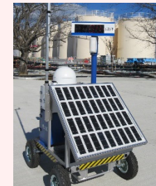
線量率モニタの設置状況
