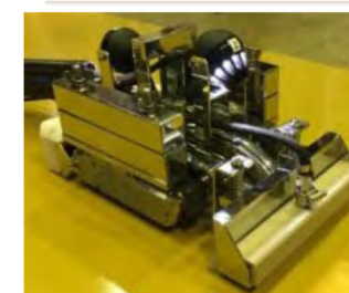
【小型除染装置】 ・HCU散水除染
