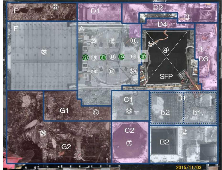
○：スペクトル測定箇所(計24箇所) 尚、⑥⑫⑯⑳はシールドプラグ継ぎ目部に位置する
