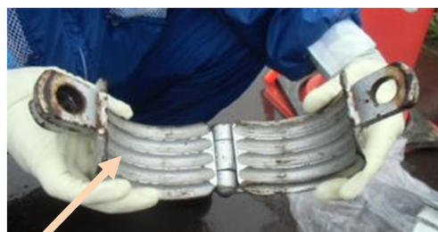
締込用バンドとホースの接触部
