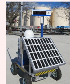
線量率モニタの設置状況
