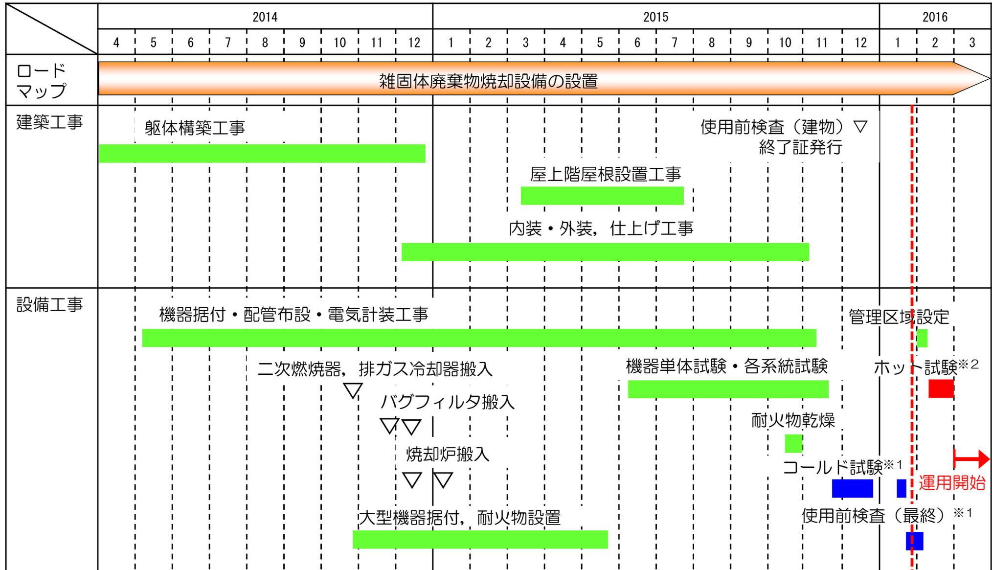
※1 コールド試験・使用前検査：汚染のない模擬廃棄物を用いた焼却試験
