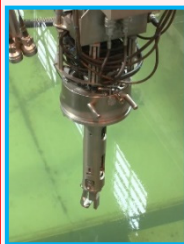
燃料把持機(マスト) 燃料取扱設備(工場内設置状況)
