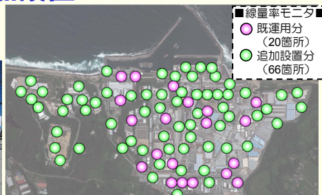
<線量率モニタ設置箇所>
