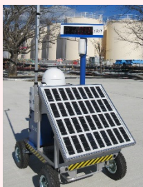
線量率モニタの設置状況
