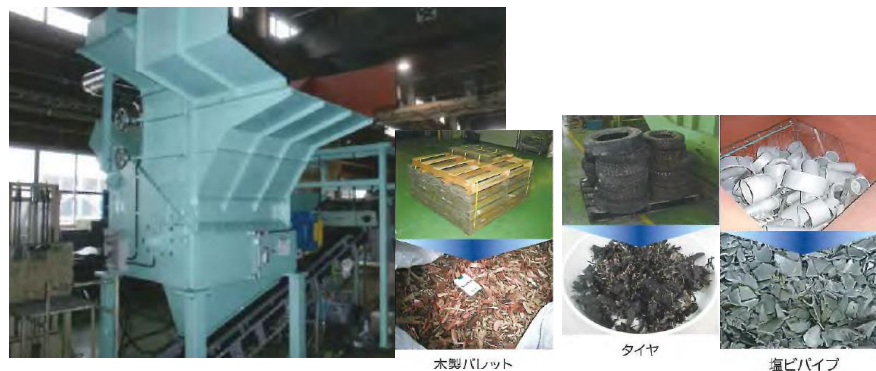
瓦礫類中の可燃物の破碎装置 例
