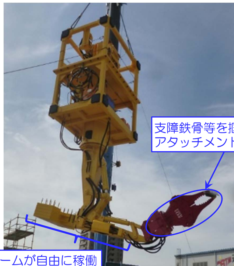
把持用アタッチメントを装着した撤去装置全景
