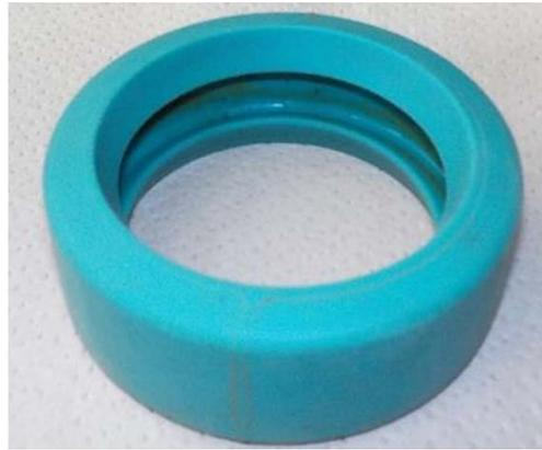
② 配管継手ゴムリング目視点検状況
