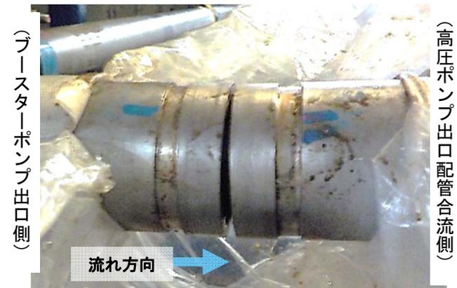
③ 継手取付部配管 目視点検状況
