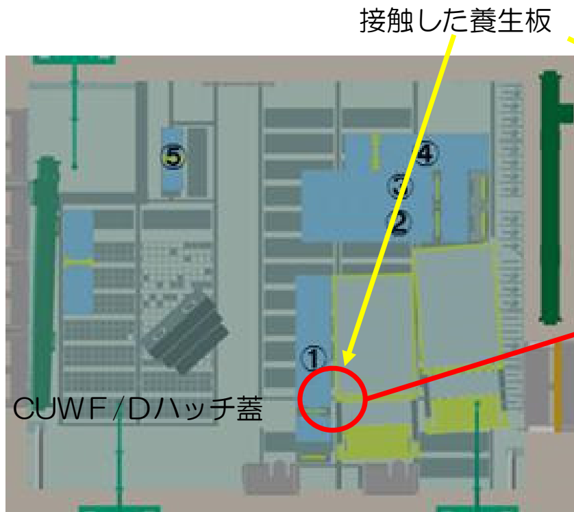
SFP内ガレキ・養生板配置図
