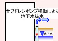
建屋へ流れ込む地下水の量を減らすため、建屋周辺の井戸 (サブドレン) からの地下水のくみ上げを2015/9/3より開始。くみ上げた地下水は専用の設備により浄化し、水質が運用目標未滿であることを東京電力及び第三者機関にて確認した上で排水。
