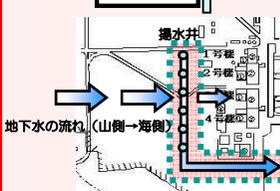
山側から流れてきた地下水を建屋の上流で揚水し、建屋内への地下水流入量を抑制する取組 (地下水バイパス) を実施。くみ上げた地下水は一時的にタンクに貯留し、東京電力及び第三者機関により、運用目標未滿であることを都度確認し、排水。建屋と同じ高さで設置した観測孔において地下水位の低下傾向を確認。建屋への地下水流入をこれまでのデータから評価し、減少傾向を確認。
