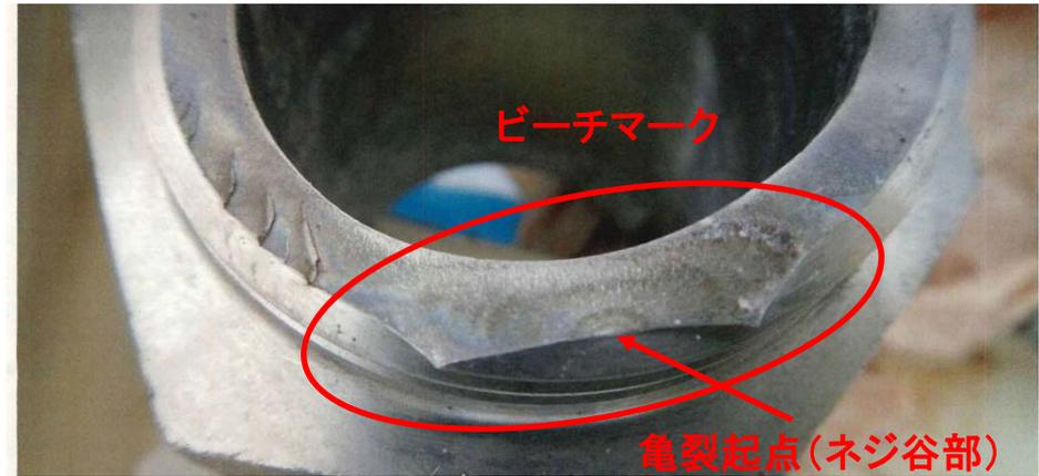
継手の破断面
