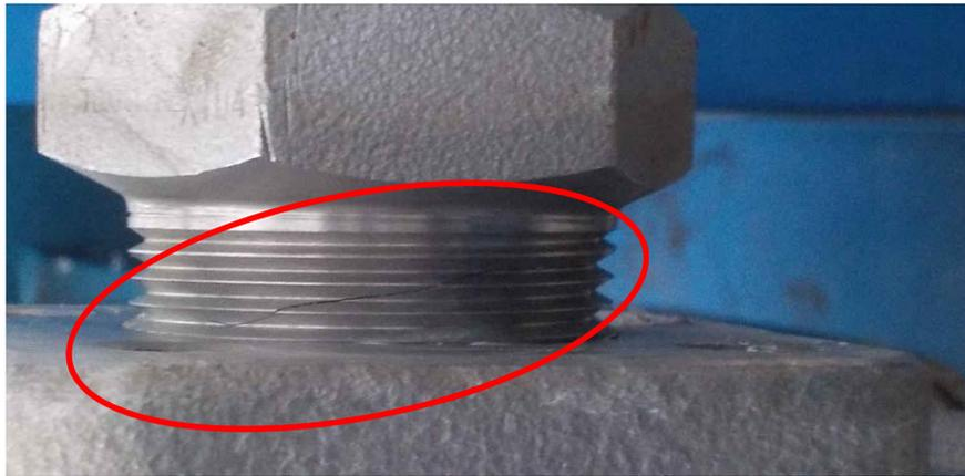
継手ネジ部の割れ
