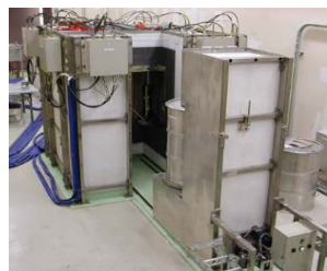
高速中性子直接問い合わせ法による非破壊測定装置
