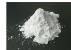
図2 捕集材の例(ゼオライトA)
