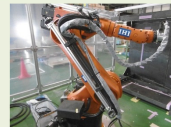
先端ツール動作確認試験の様子
