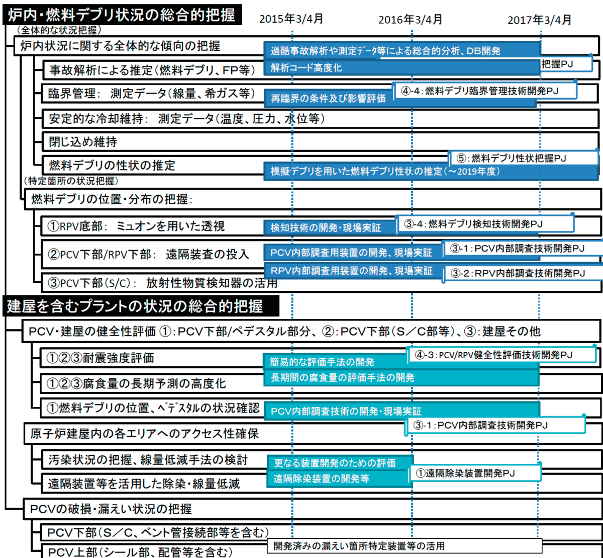
図 6-3 燃料デブリ取り出し関連研究開発の体系 I : 炉内状況把握の高度化
