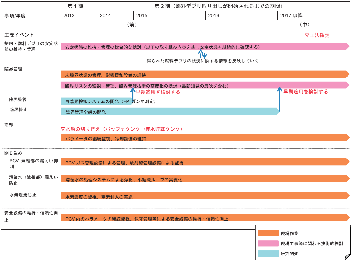
図 4.2-7 燃料デブリ取り出し開始までの期間における炉内・燃料デブリの安定状態維持・管理に関する今後の対応
