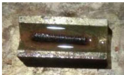
試験体A発錆の状態
