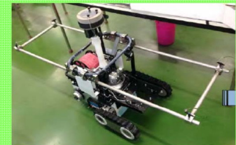
ケーブルガイド (運搬用サポートに利用) 運搬用治具取付状態
