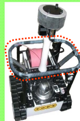
ケーブルガイド (運搬用サポートに利用) 運搬用治具取付状態
