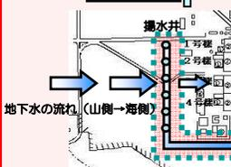
山側から流れてきた地下水を建屋の上流で揚水し、建屋内への地下水流入量を抑制する取組(地下水バイパス)を実施。くみ上げた地下水は一時的にタンクに貯留し、東京電力及び第三者機関により、運用目標未達であることを都度確認し、排水。揚水井、タンクの水质について、定期的にモニタリングを行い、適切に運用。建屋と同じ高さで設置した観測孔において地下水位の低下傾向を確認。建屋への地下水流入をこれまでのデータから評価し、減少傾向を確認。
