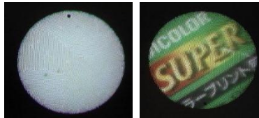
A. 高OH基含有石英 イメージファイバ (近赤外観察用)
