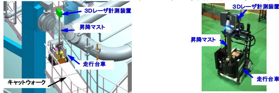
図 13：1号機トラス室3Dレーザスキャン計測イメージ図
